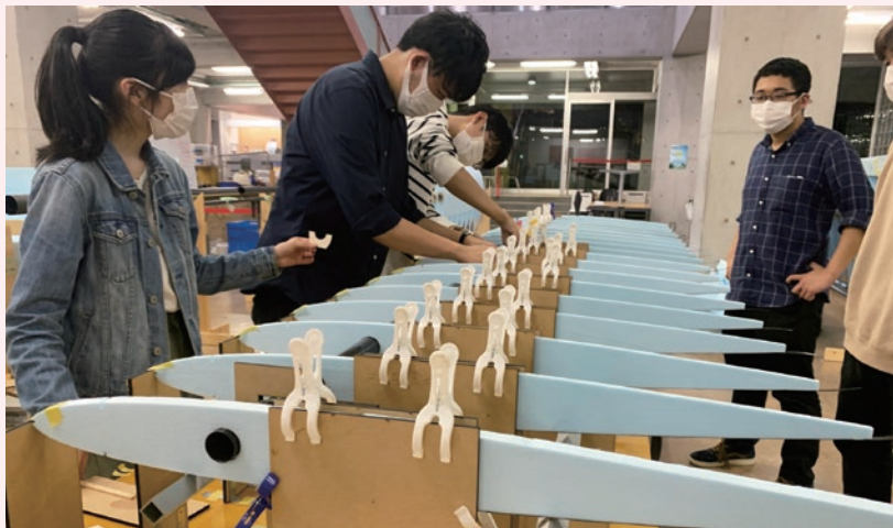
リブセツ（翼の断面を軸に通して接着する作業）を行う増本さん（左）
